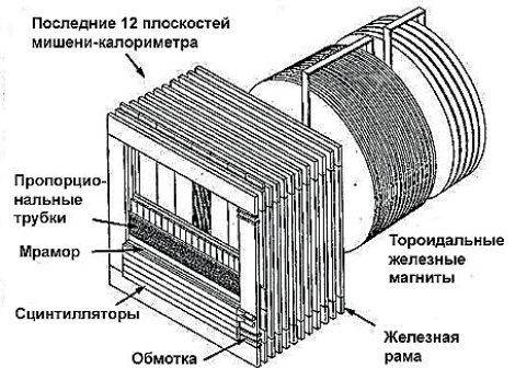
Рис. 2. Эксперимент CHARM (WA-18) на ускорителе SPS CERN. Слева — общий вид детектора, справа — его схема.
