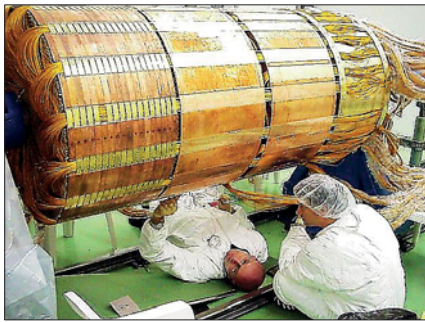
Рис. 3. Один из двух передних калориметров ATLAS перед установкой.
