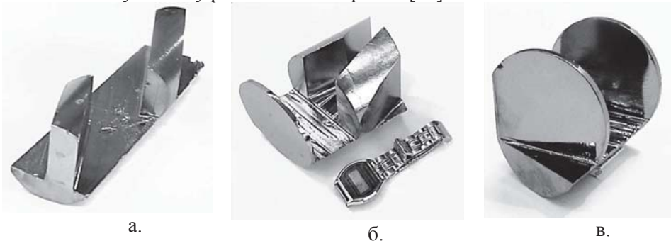
Рис. 12. Кристаллические пары в схеме Брэгг-Брэгг (а), Лауэ-Брэгг (б) и Лауэ-Лауэ (в), которые вырезаны из единых монокристаллических слитков бездислокационного кремния. Отражающие поверхности пластин совпадают с кристаллографической системой плоскостей.
