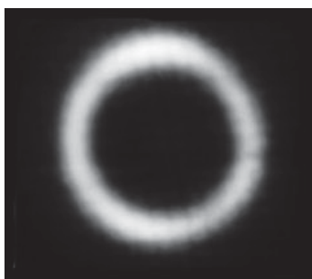
Рис. 7. Поперечный профиль пучка ионов \text{Fe}^{+26} в режиме формирования плазменной линзой трубчатого пучка диаметром 9 мм.
