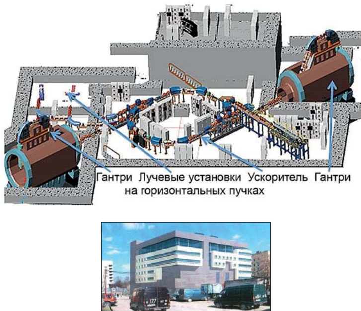
Рис. 8. Центр ПЛТ при ГКБ им. С.П. Боткина (проект). Вверху — схема размещения оборудования. Внизу — здание центра (компьютерная графика).
