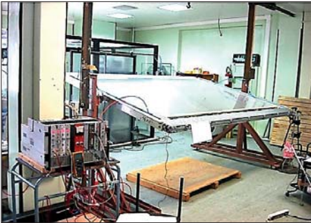
Рис. 7. Испытание дрейфовой камеры с размером чувствительной зоны 2400 \times 1600 \text{ мм}^2 .
