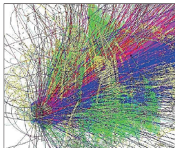
Рис. 9. Пример события, типичного для эксперимента СВМ. Картина получена методом Монте-Карло для центрального столкновения ионов золота при энергии 25 ГэВ/нуклон.
