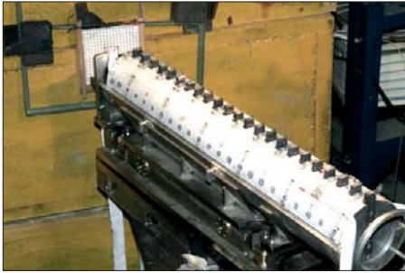
Рис. 1. Облучение «толстой» Pb мишени вместе с пороговыми образцами на выведенном пучке ускорителя У-10.
