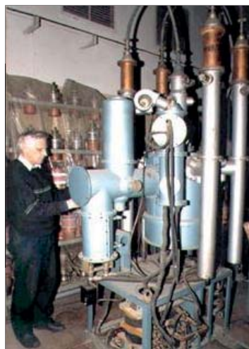
Рис. 21. Разработанные в ИГЭФ мощные ВЧ генераторы на частоту 80 МГц (слева) и 300 МГц (справа).
