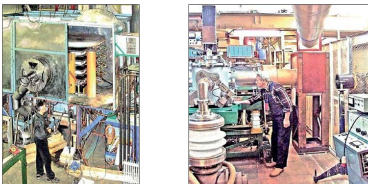
Рис. 9. Лазерное получение ионов: слева — лазер Л-100 (на энергию 100 Дж), справа — наладка мишенной камеры лазерного источника ионов.
