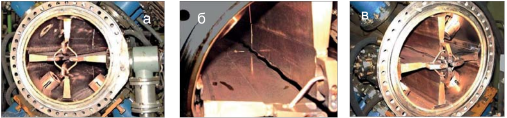
Рис. 6. Секция НЧУ-2: а — входной растроб канала с антидипольными связками; б — одна из 4-х камер выходной секции, хорошо видна волнообразная модуляция электродов; в — выходной узел канала с динамическим согласователем и антидипольными связками.
