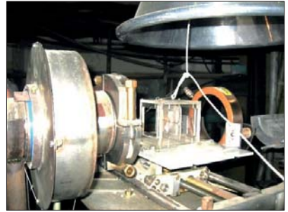
Рис. 2. Облучение «тонких» мишеней протонами с энергиями 40÷2600 МэВ на выведенном пучке ускорителя У-10.
