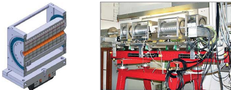
Рис. 22. Слева — схема ПМК линзы прототипа микроскопа PRIOR; справа — фокусирующий квадруплет.
