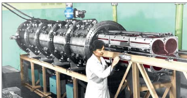
Рис. 3. Первый полномасштабный ускоритель с ПОКФ и 4-камерным резонатором — НЧУ-1. Слева — входная секция, справа — настройка составного резонатора перед вкатыванием в вакуумный кожух.
