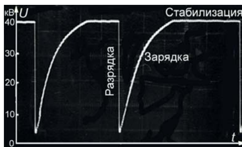
Рис. 17. Осциллограмма стабилизации напряжения на высокоэнергетичном емкостном накопителе.
