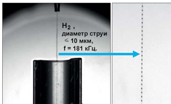
Рис. 8. Тенеграфическая фотография режима управляемого монодисперсного распада криогенной струи сжиженного газа на микромишени.
